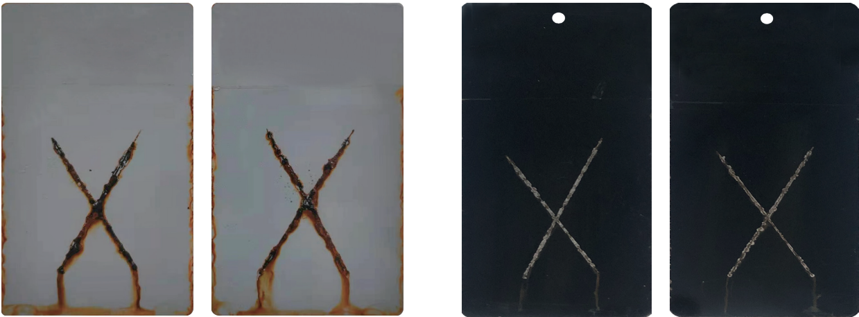
固化温度 180℃ /20min, 膜厚 20μm,1000h, 黑 / 灰产品划叉处单边腐蚀宽度 ≤ 1.5mm。 180℃ / 20min Film thickness 20μm 1000h, black/grey fork single side corrosion width ≤ 1.5mm.
